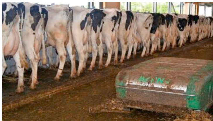
Zwei Roboter reinigen täglich jeweils 8000 m 2 . Damit die Kühe währenddessen in Ruhe fressen können, stehen sie auf erhöhten Fressständen.
